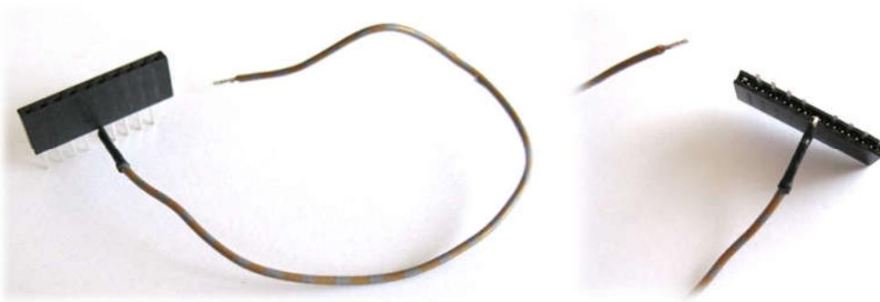
Zusätzliche Isolierung (Isoband...) auf Höhe von Pin14 zur unteren Fassung hin ist bei dieser Buchsenleiste bauartbedingt nicht erforderlich.
