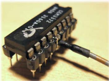
Wir gehen bei jedem Filter IC gleichermaßen vor. **Achtung:** es wird dringend empfohlen, vor dem Einbau ein doppeltes Stückchen Isolierband unterhalb von Pin14 auf die Originalfassung zu kleben, damit dieser Anschluss *ganz sicher* keinen Kontakt „nach unten“ hat. Weiterer Vorteil: Der Pin14-Kelch hängt etwas lose herum, mit dem Isolierband von unten hat das ganze Konstrukt mehr Festigkeit.
